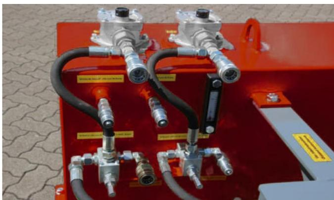
Hydraulikaggregat an Dreipunkt mit Aufsteckpumpe und Tank
