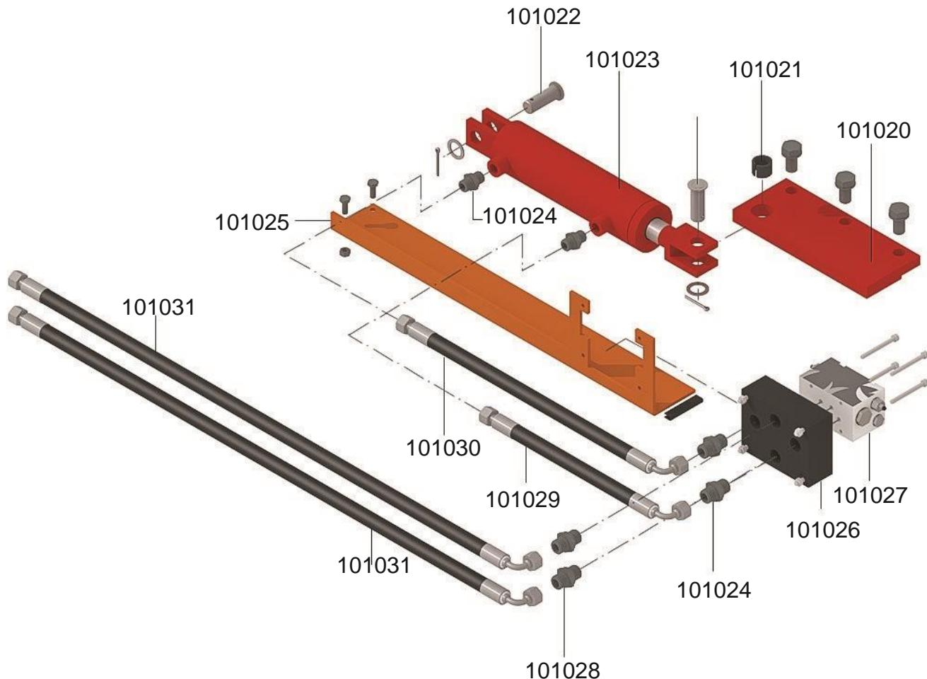
Hydraulikschläuche haben eine Verwendungsdauer von 6 Jahren. Abgelaufene Schläuche müssen durch neue Schläuche ersetzt werden!
