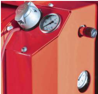
Praktische Einrichtung zur Überwachung des Systemdrucks und des Drucks einzelner Funktionen (Ziehen, Proportionalbremse, Seilausstoß)
