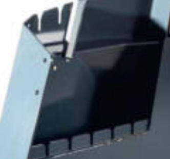
Große Ablagen vorne an der Winde, damit der Schmutz von Schlepperrädern nicht die Ketten und das andere Zubehör erreicht.
